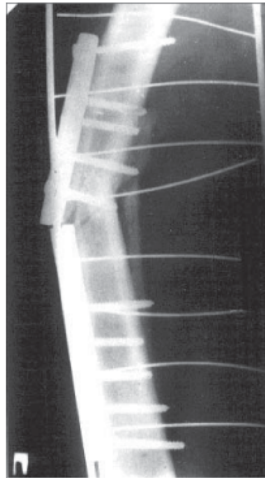
Рис. 2. Зруйнування накісткової пластини.
