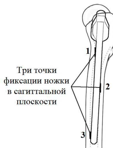
Рис. 1. Схема контакта эндопротеза с кортикальной костью в сагиттальной плоскости.
