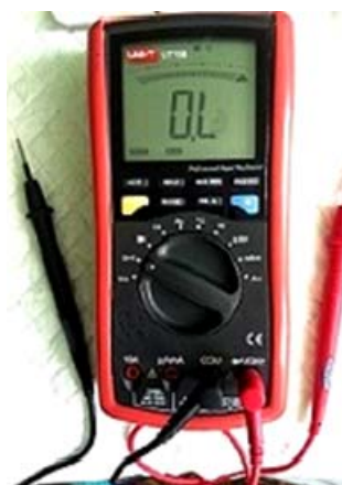
Рис. 1. Загальний вигляд пристрою «мультиметр цифровий UT70В».
